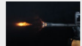
Vakio A1 bird cage -liekinsammutin, M4-tyyppinen karbiini 14.5" piipulla.
